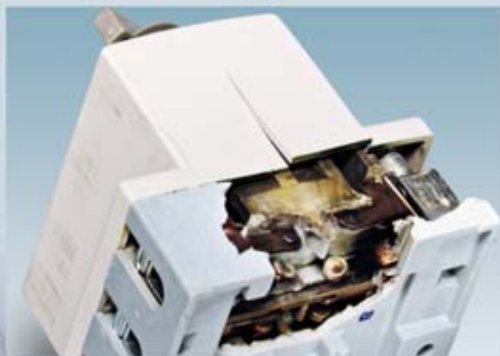
Рис. 1б: Поврежденный дифференциальный автоматический выключатель (RCD)
