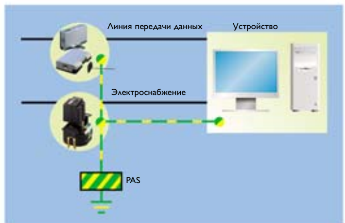
Рис. 6.4-2: DATATRAB и PRINTRAB - защита питания и сигнальных линий
