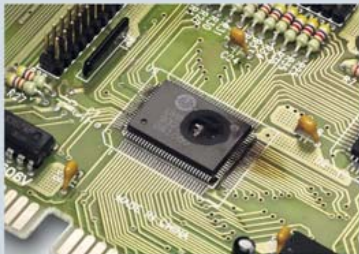
Рис. 1а: Интегральная микросхема, разрушенная в результате воздействия импульсных перенапряжений
